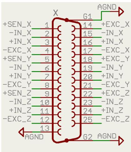
Abbildung 3 Anschlussbelegung Aufnehmer
